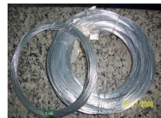
Arame galvanizado comum 14 ou 16. Adequado para pequenos projetos.
