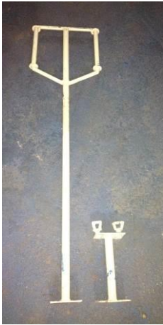
Bate estaca para estaca de ferro
